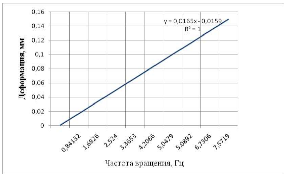
Рисунок 4.17 – Деформации вала на пятой форме, рассчитанные по модели 2
